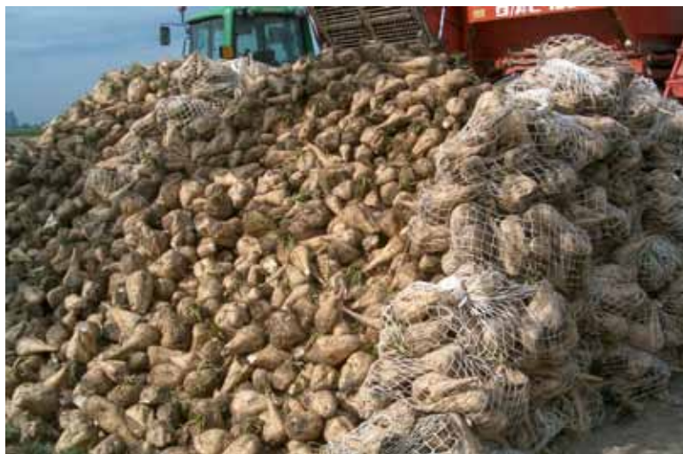
Foto scattata durante le prove sperimentali di stoccaggio per valutare l'evoluzione del processo e quantificare le perdite. Nella rete vi sono alcuni dei campioni esaminati.
