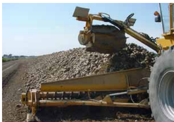
Foto 1. Caricatore-sterratore in azione: il cumulo dovrà essere dimensionato in base alla sua dimensione operativa
